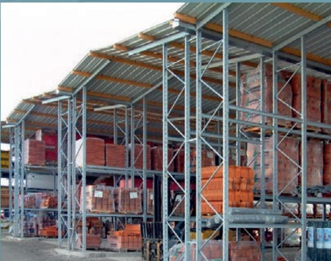
Systèmes de rayonnages à palettes ouverts pour l'entreposage de matériaux de construction. Étagère à double colonne, entièrement galvanisée, montée sur des blocs de fondation.
