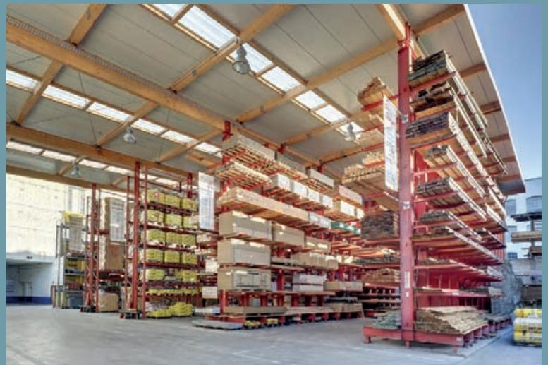
Hall de rayonnages à structure ouverte. Compromis entre le système d'étagères à bras portants et étagères à palettes, avec une toiture autoportante. Grande luminosité et longueur confortable pour le passage des camions.
