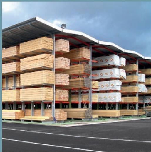
Hall de rayonnages d'une grande entreprise de négoce en bois. Toiture en tôle bac acier, entrecoupée par des panneaux d'éclairage naturel. Conçu pour un entrepôt à allées étroites avec rails de guidage.
