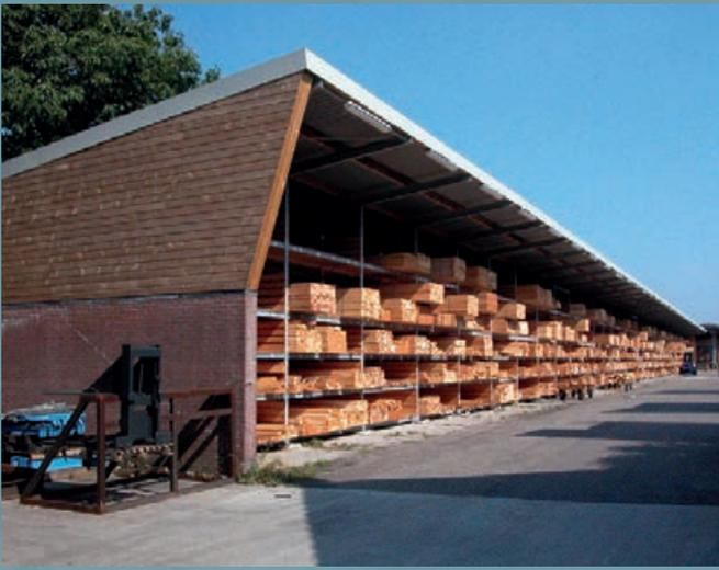
Système de rayonnages à palettes fermé sur trois côtés, pour l'entreposage du bois avec différentes marchandises et dimensions dans le sens de la profondeur. Large déport de toiture.
